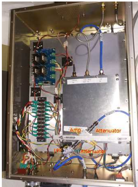
<그림 6-22> 전력 증폭기가 추가된 주파수 합성기의 차폐 상자 내부 사진(좌)과 주파수 합성기 출력 전력(우)
