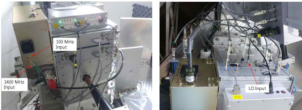
<그림 6-28> 주파수 합성기를 22GHz 수신기 옆에 설치한 사진
