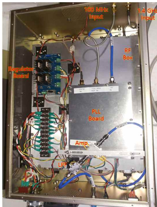
그림 A-5. 주파수 합성기 내부 점검 항목; Regulator 보드 입, 출력 전압, 내부 단자들과 RF 부품들의 고정 상태와 커넥터의 연결 상태를 확인한 후, 풀린 부분이 있으면 조인다
