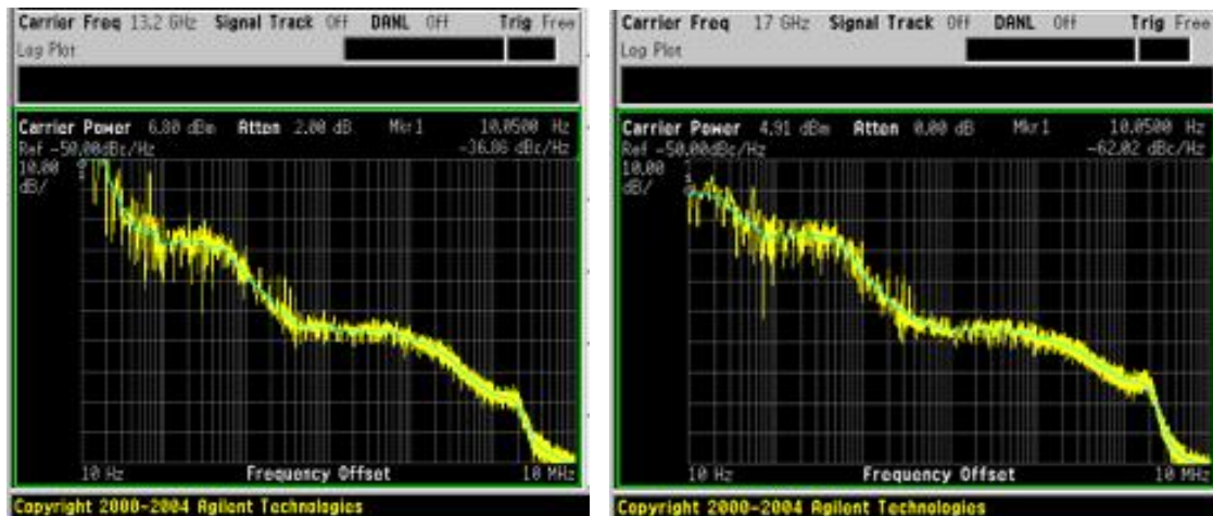
<그림 6-24> 13.2GHz와 17GHz에서의 주파수 합성기 위상 잡음 측정 결과
