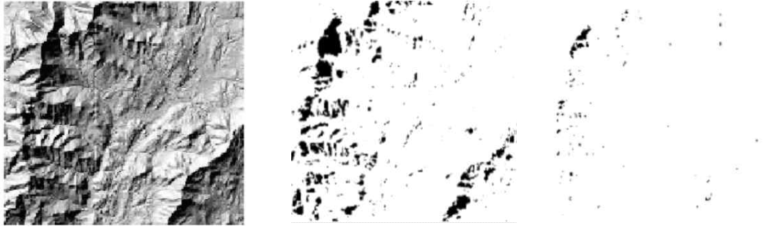
<그림 2-52> Hillshade와 태양 고도각에 따른 그림자 탐지 결과 고도각 낮음(가운데) / 고도각 높음(오른쪽)
