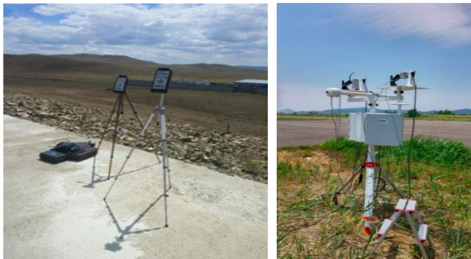
<그림 2-6> 대기 측정 장비(좌: MFRSR, 우: Microtops II 장비) (Yeom et al., 2017; 2018)
