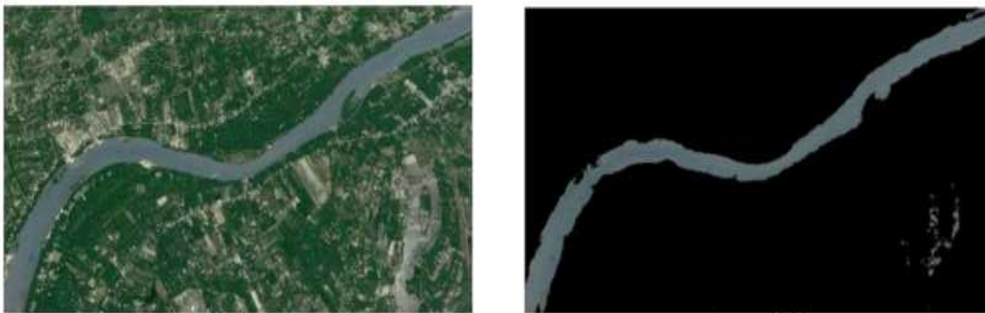
<그림 2-71> 원본 영상(왼쪽) 및 K-means Clustering 기반 수계 추출 결과(오른쪽)
