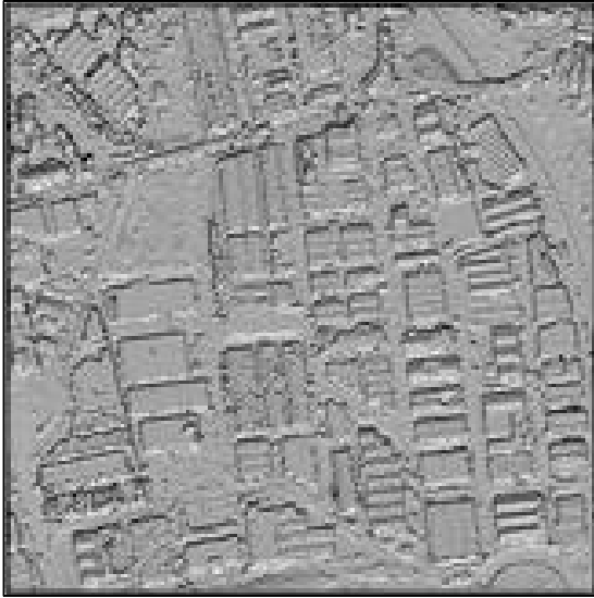
<그림 2-69> 고정밀 DSM 기반 Hillshade 알고리즘 적용 결과
