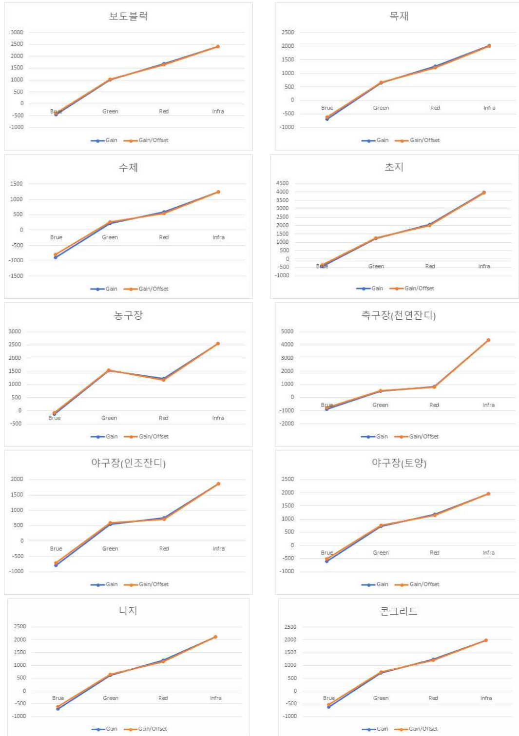
<그림 3-18> 1st 복사보정계수 (gain vs. gain & offset mode) 적용에 따른 지표물별 반사도 비교
