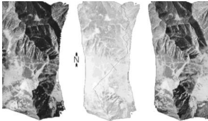
<그림 2-14> 중복영역에 대한 정사영상(left and right)과 계산된 Epho 영상(middle)
