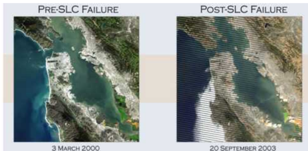
<그림 2-77> Landsat 7 ETM+ 영상 오류 예시
