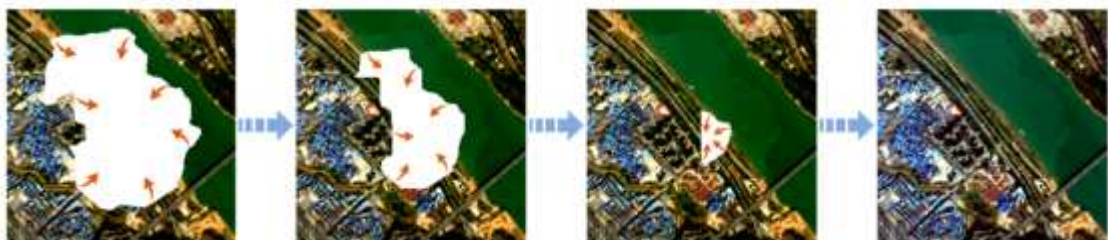
<그림 2-83> 순차적 국부 방사 조정 방식(SRARC) 기반 대상 이미지의 구름 영역 복원 과정
