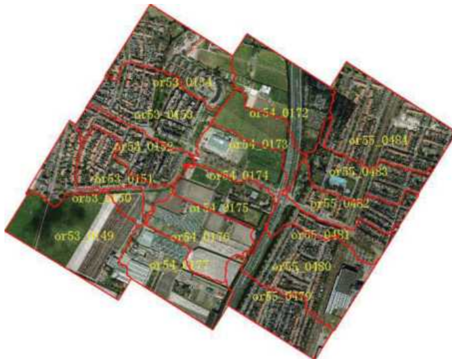
<그림 2-9> 개선작업을 거쳐 최종 획득된 접합선 네트워크 (Pan et al., 2014)
