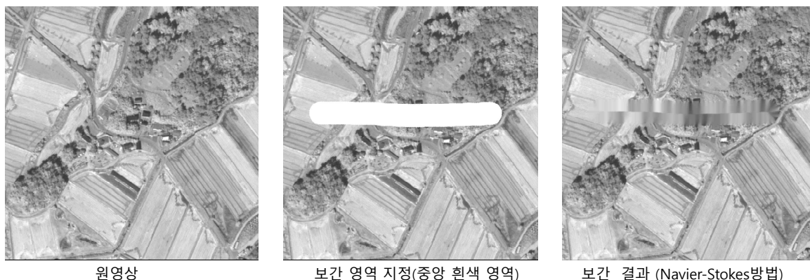
<그림 2-99> Navier-Stokes 방법을 이용한 실험 결과
