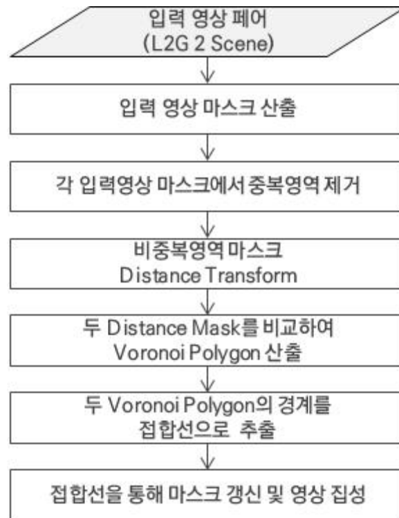
<그림 2-27> Voronoi Diagram 기반 모자이크 알고리즘 순서도 (Flowchart)
