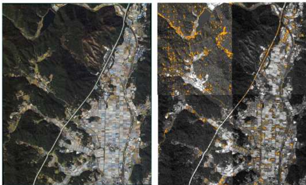
<그림 11-1> 공간객체추출 SW 이용 AI 기반 도로객체추출 테스트 결과(좌: 위성영상, 우: 도로추출 결과(노란색 영역))
