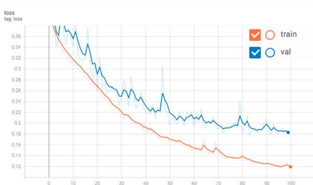
<그림 10-11> 이중 센서 영상의 U-Net 트레이닝 및 검증 결과
