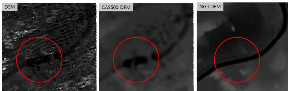
<그림 7-7> DSM의 하천 표현 오류로 인한 DTM 오류
