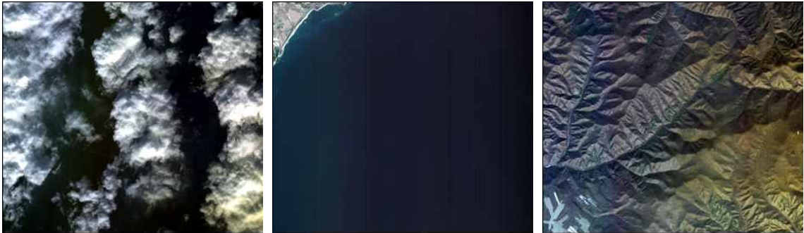
<그림 1-5> GCP Chip 부족으로 위성정사영상이 자동생산되지 않은 경우 (좌) 기상 영상으로 영상융합 불가능 (중) 해양지역 (우) 산간지역
