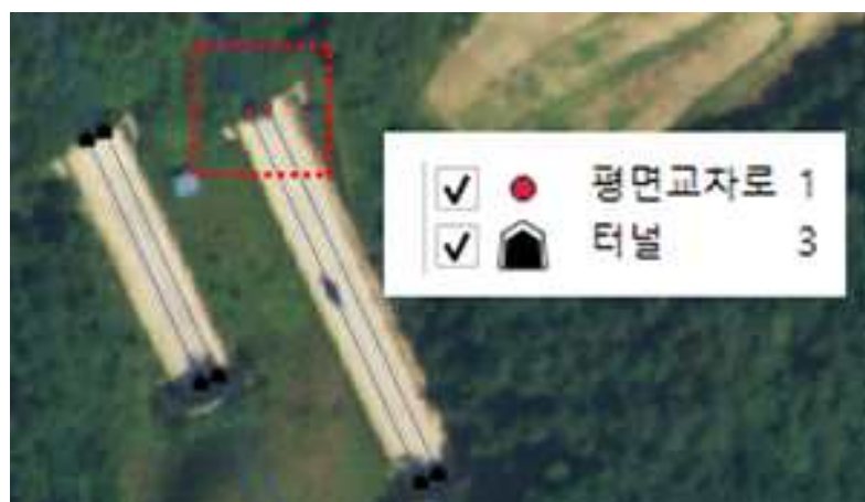
<그림 35> 노드의 타입(Type) 속성이 실제로 터널(3)이나 평면교차로(1)로 입력된 오류 예시
