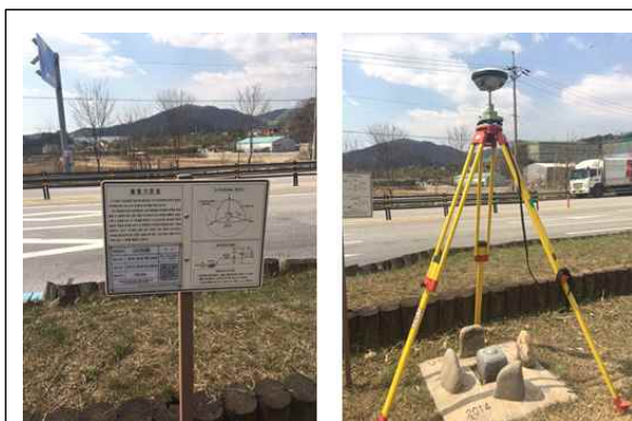
&lt;그림 10&gt; 이동기지국 설치
