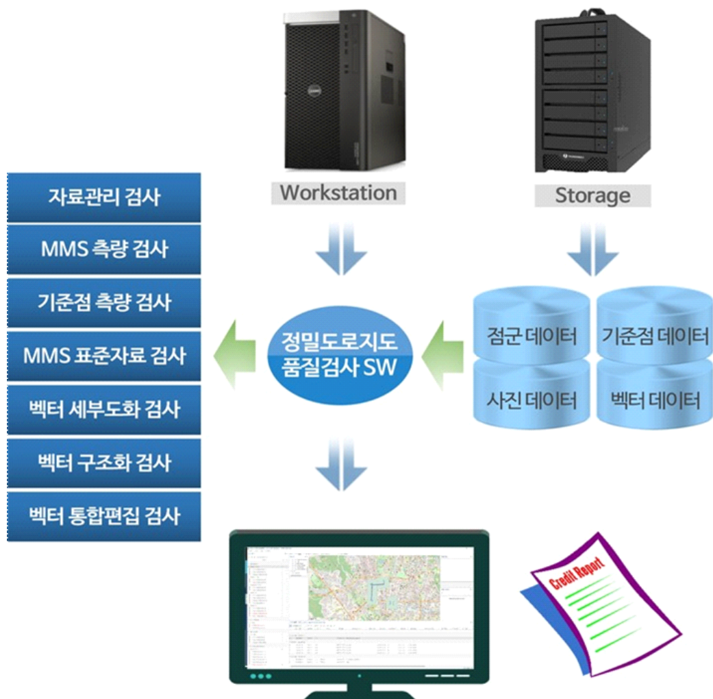
<그림 4-2> 정밀도로지도 품질검사 SW 시스템 구성도
