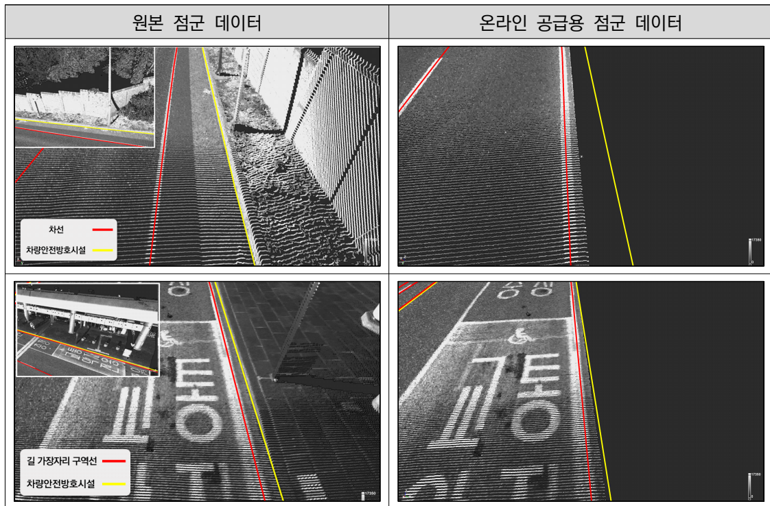
〈그림 3-13〉 온라인 공급용 점군 데이터 제작 예시
