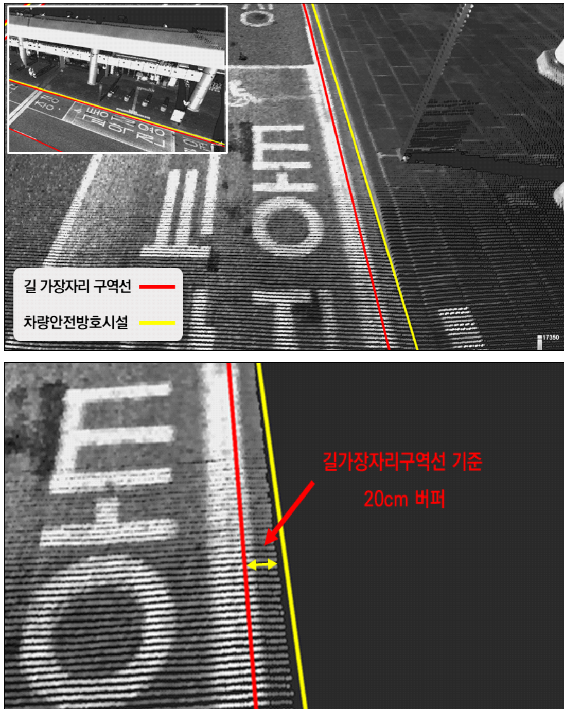
〈그림 3-12〉 온라인 공급용 점군 데이터 제작 범위(쪽)
