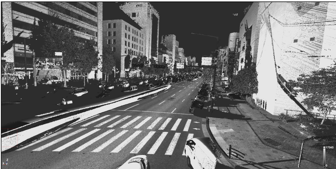
<그림 3-10> MMS 측량 성과(점군 데이터) 예시
