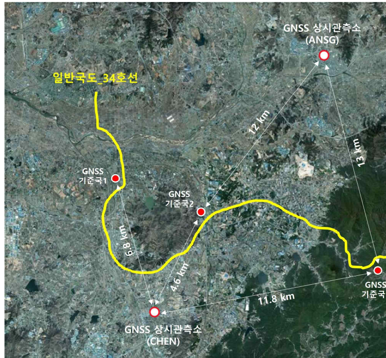
[그림 6.1] GNSS 기준국 배치도 예시
