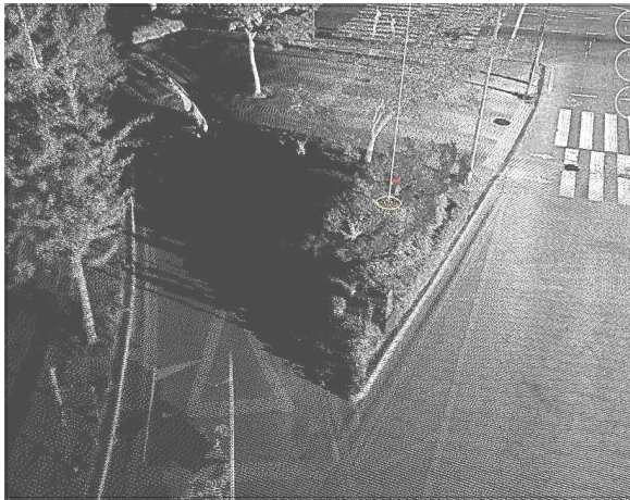
(a) 올바르지 않은 MMS 측량 사례(정군 누락)
