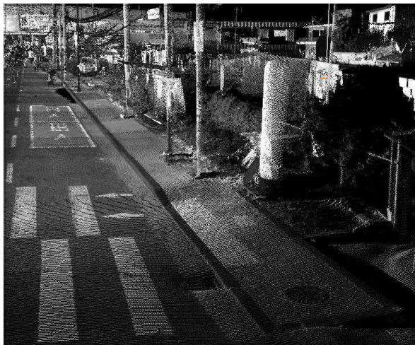
[그림 9-7] 보도/자전거도로(PW1_PATHWAY) 도화 예시 - 보도
