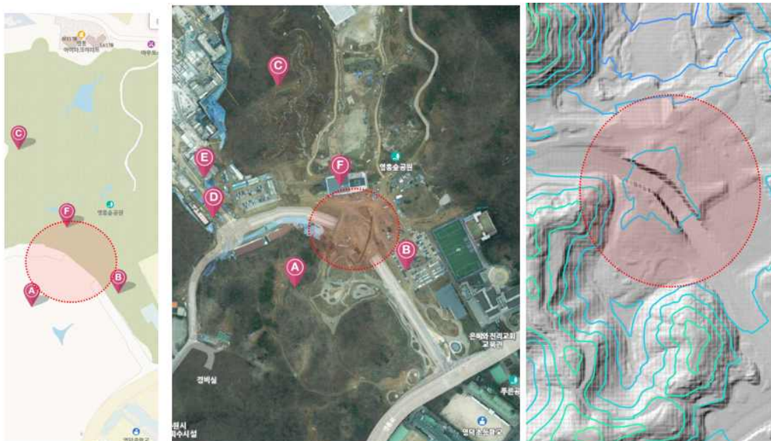
<그림 3-42> DEM 분석 - 터널과 도로가 만나는 부분에 수치표고모형에 경사급변선 확인
