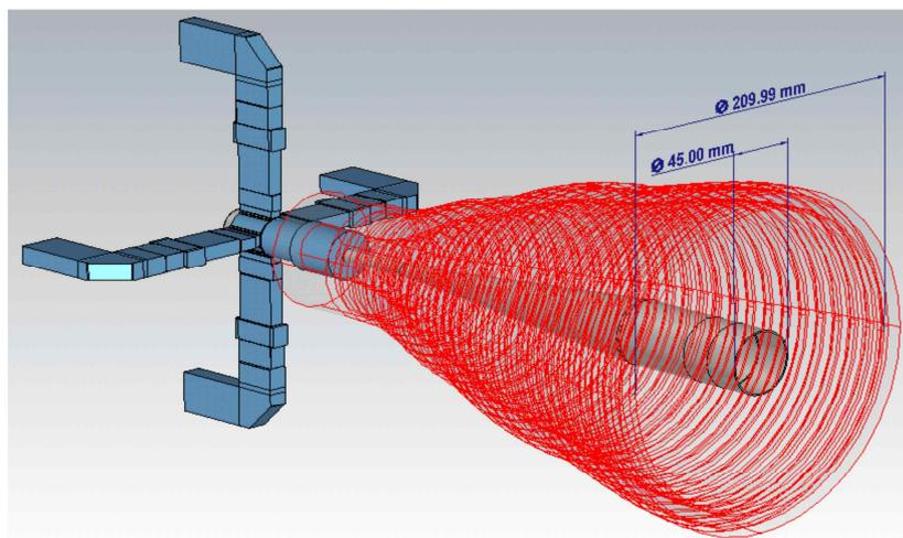
Figure 3-4. C/X/Ka band Feedhorn
