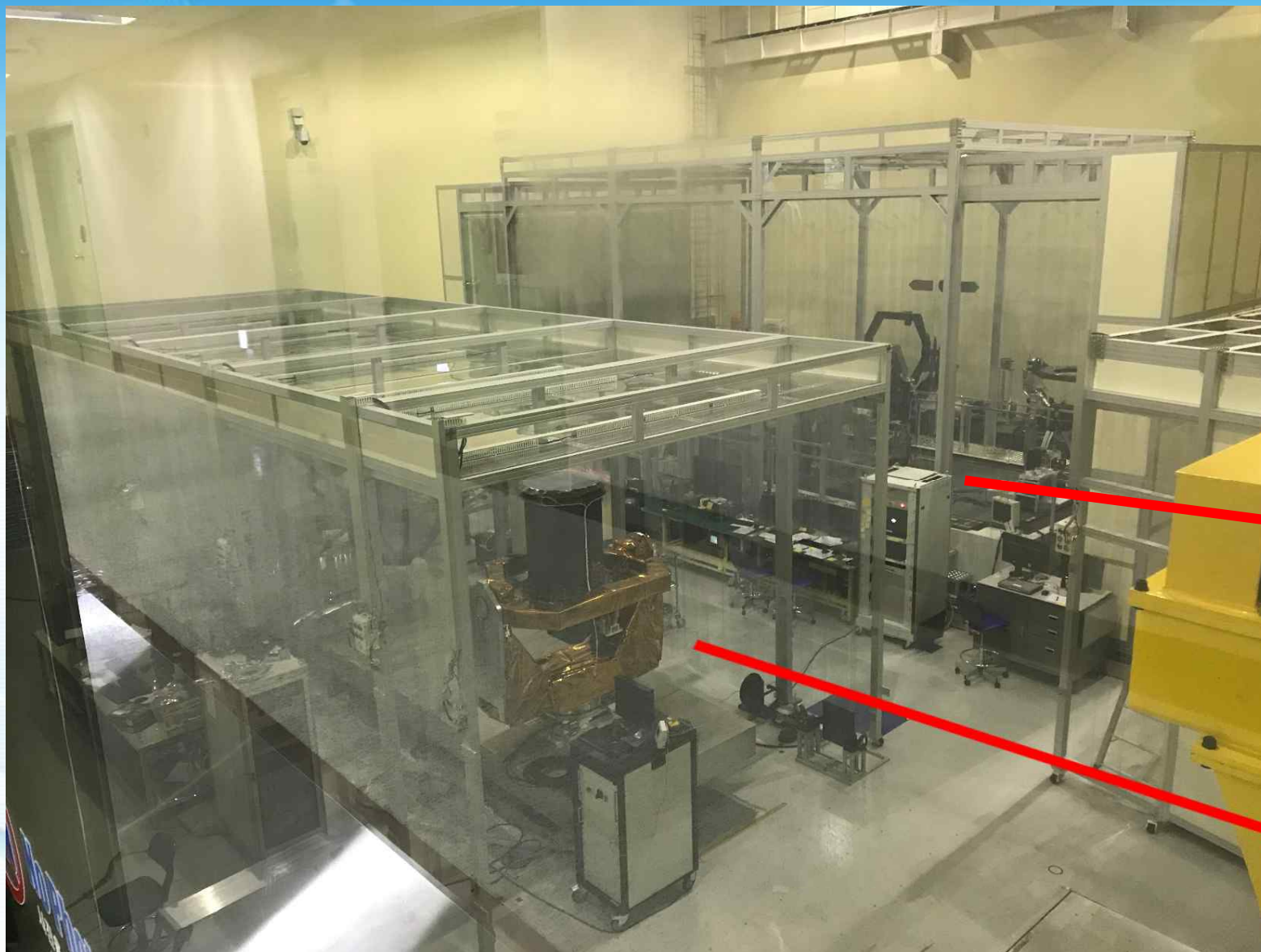
항공우주연구원 광학시험실(TH#9) 내 차세대중형위성 탑재체 조립/정렬/시험 진행 중
