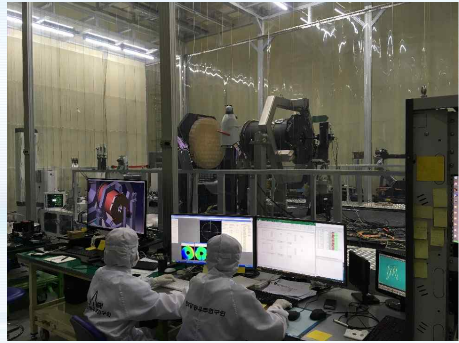
항공우주연구원 광학시험실(TH#9) 內 차세대중형위성 탑재체 비행모델 광학모듈 FM1 조립/정렬/시험 진행 중
